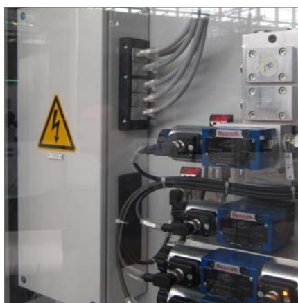
KEL 24|10 - Seite 6 / BPK 24 - Seite 140 Einführung von 6 Leitungen mit nur einer Kabeleinführungsleiste. Ein zweiter Ausbruch ist mit einer Kunststoff-Blindplatte BPK 24 versiegelt.
