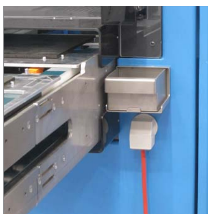
KVT 50-W90 - Seite 28 Teilbare Winkelverschraubung zur Einführung einer Leitung des Bedienpanels.
