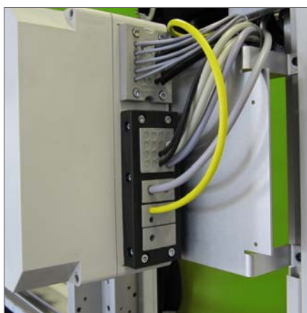
KEL-DPZ B25 Seite 54 / KEL 24|7 Seite 6 Kombination von teilbaren Systemen und Durchstecksystemen zur Einführung von Leitungen in einen in die Maschine integrierten Schaltschrank.
